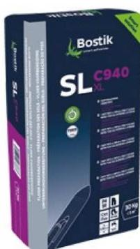
SL C940 XL dient im Innenbereich zum Spachteln, Ausgleichen und Nivellieren von Estrichen, Schnellestrichen und Rohbetondecken im Verbund. Für Schichtdicken von 5 bis max. 50 mm\* geeignet. Zur Untergrundvorbereitung vor Parkett- und Bodenbelagsarbeiten sowie Fliesen- und Plattenarbeiten. Trockenbaukonstruktionen sowie Gussasphaltestriche sind mit anderen geeigneten Spachtelmassen zu bearbeiten.
