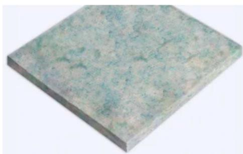
Entkoppelnde und schalldämmende Unterlage für alle Arten von Oberbelägen wie Keramik, Naturstein, Parkett und nach einer Spachtelung auch für Teppichböden und Kunststoffbeläge geeignet. Die Platte kann z.B. auf Estrichen, gespachtelten Betonflächen und alten Hartbelägen eingesetzt werden. Auf Lager haben wir die Formate 1000 x 600 x 4 - 9 - 15 mm
